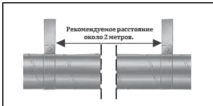
Для диаметров до d1 355 мм
