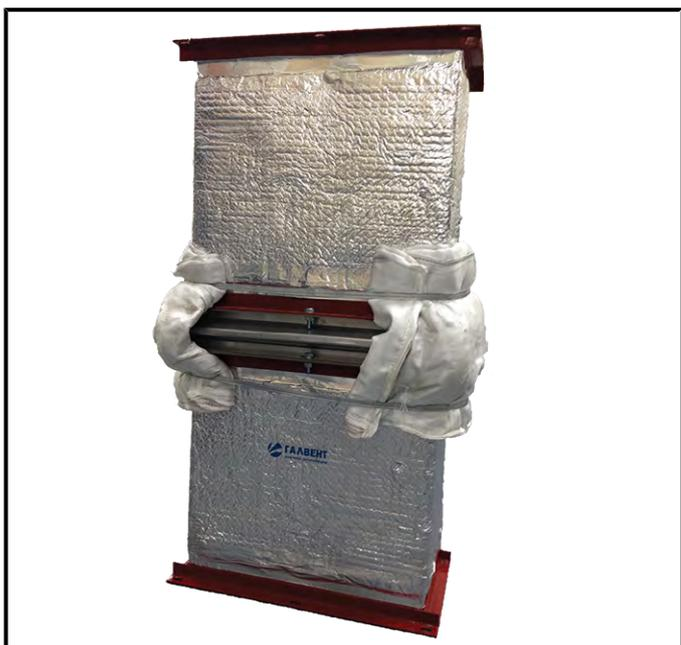
В нормативных документах, СНиП и СП отсутствуют точные требования по шагу установки компенсаторов линейных тепловых расширений. На основе расчетов «Фабрика Вентиляции ГалВент» дает рекомендации по установке компенсаторов линейных тепловых расширений с шагом расположения не более 20 метров.
