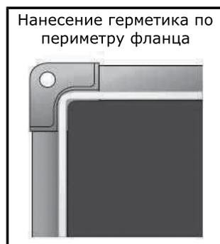
Угловое уплотнение важно, так как углы часто могут быть источником утечки. Вследствие различных значений длины стенок воздуховода (например, неаккуратные фальцы), может легко образоваться щель, которую невозможно ликвидировать с помощью уплотнительной прокладки воздуховода. Распределение герметика на основе мастики в углублениях угла может предупредить риск такой утечки.
