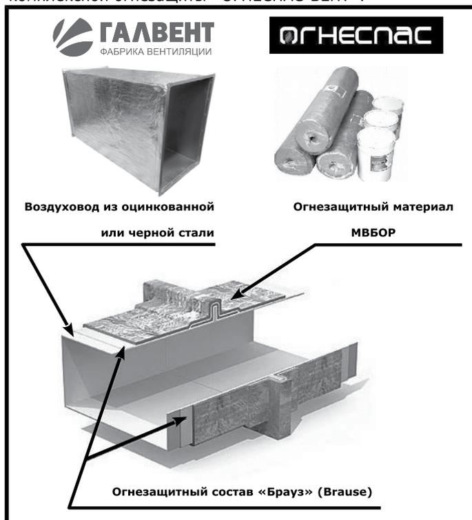
Воздуховоды и фасонные изделия из оцинкованной стали, сварные из черной стали в огнезащитном покрытии «ОГНЕСПАС-ВЕНТ» прошли все необходимые испытания согласно ГОСТ Р 53299-2013 «воздуховоды. Метод испытания на огнестойкость», что подтверждается сертификатом пожарной безопасности №С-РУ.ЭО 31.В.00633 ТР1390847
